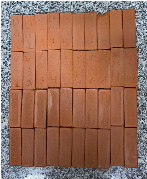
Figura 2- Corpos de prova após a sinterização na temperatura de 900°C.
