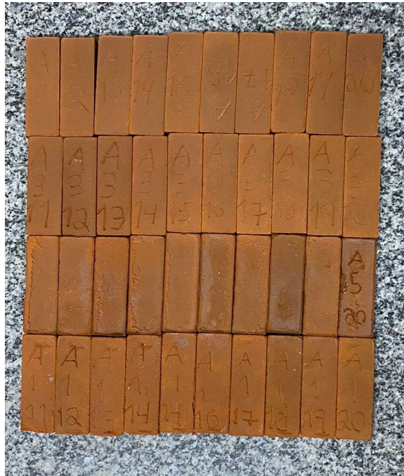
Figura 3- Corpos de prova após a sinterização na temperatura de 1000°C.
